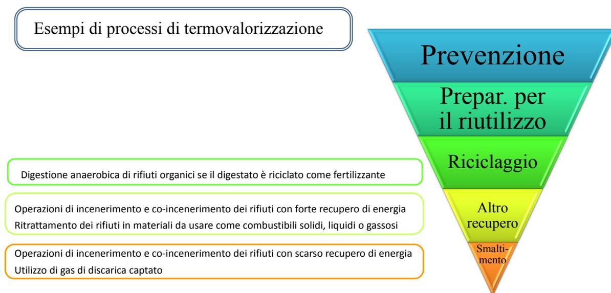
**Figura 1. Gerarchia dei rifiuti e processi di termovalorizzazione**
