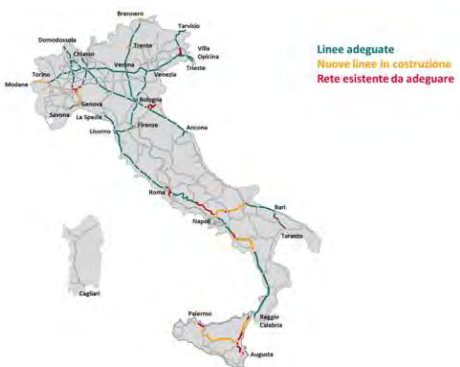
Figura – Linee adeguate e da adeguare sulla rete centrale merci in relazione allo standard di carico assiale D4
