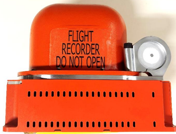
Recorder CVR presente a bordo dell'S64 marche I-CFAG, le cui tracce audio sono state acquisite presso i laboratori ANSV.
