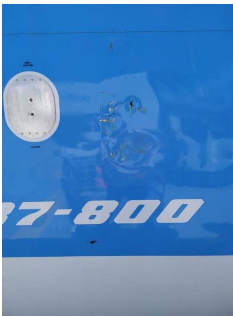
Anno 2019: esempio di danneggiamenti prodotti da un mezzo di rampa sulla fusoliera di un B737-800.
