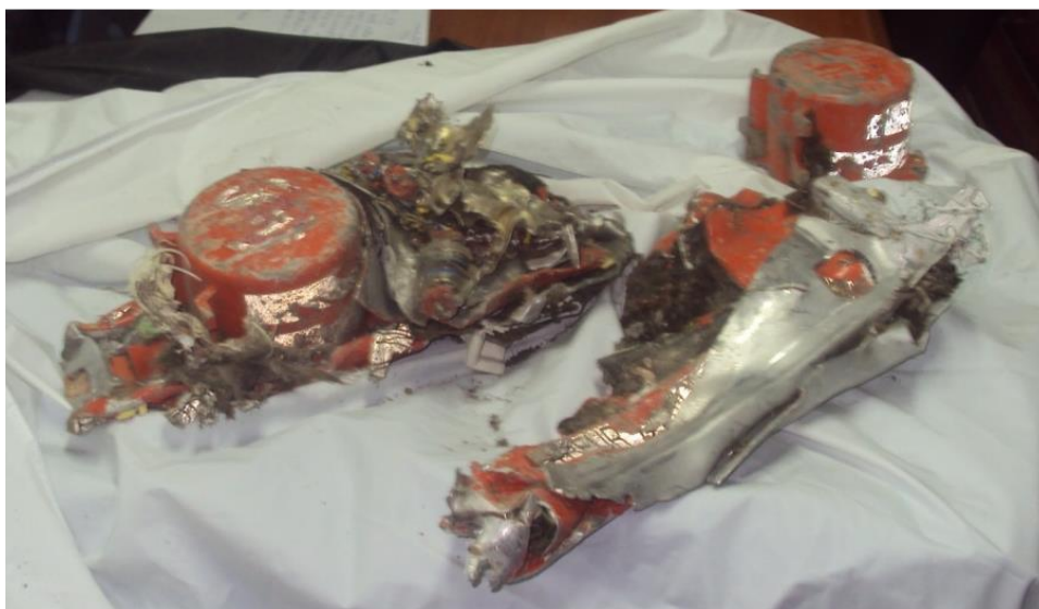
I registratori di volo del B737 MAX 8 marche ET-AVJ, recuperati nel luogo dell'incidente.
