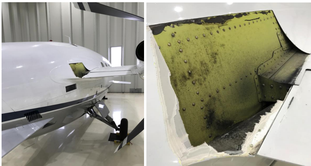
A sinistra, il P180 Avanti marche M-PIRE; a destra, particolare del pannello mancante.
