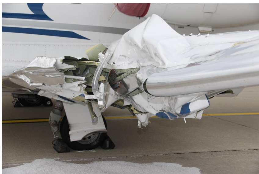
Primo piano dei danni riportati dalla semiala sinistra del Cessna Citation 560 XLS+ marche OE-GES.
