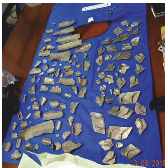
Frammenti metallici provenienti dal motore del B787-8 LN-LND recuperati presso l'abitato di Fiumicino.
