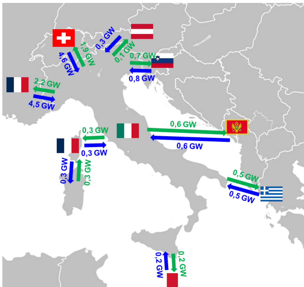
Figura 1 – Capacità di scambio transfrontaliera in import ed export delle interconnessioni esistenti (elaborazione max NTC 2023 e limiti di transito - fonte Terna)
