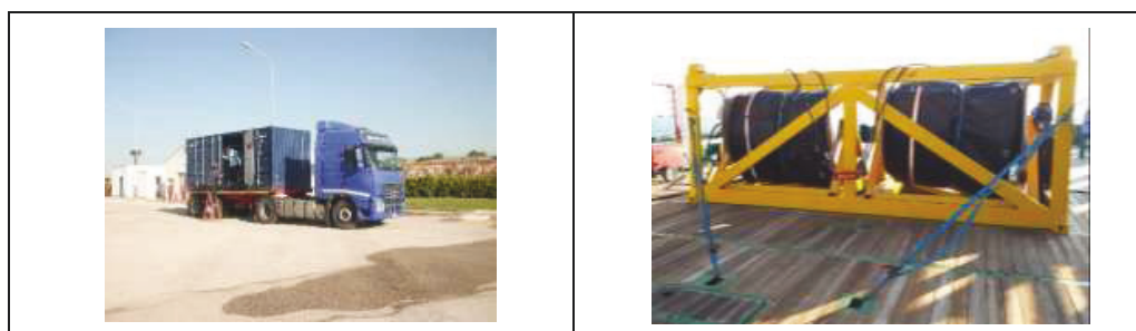
Figura 7 – Container materiale e skid panne oceaniche
