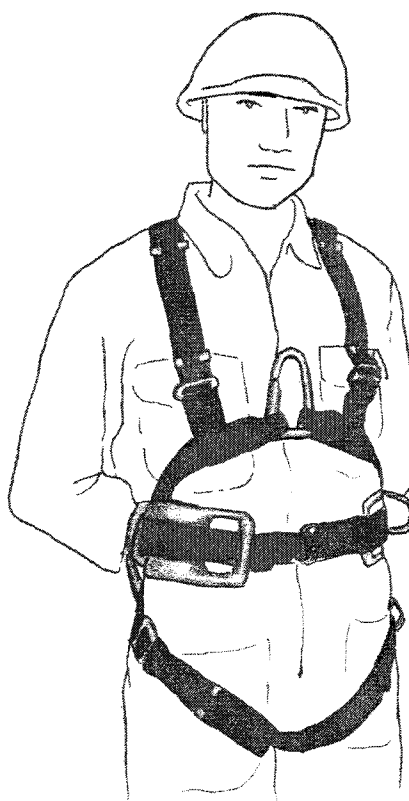
Fig. 15 - Imbracatura per il corpo con cintura di posizionamento integrata ed attacco sternale
