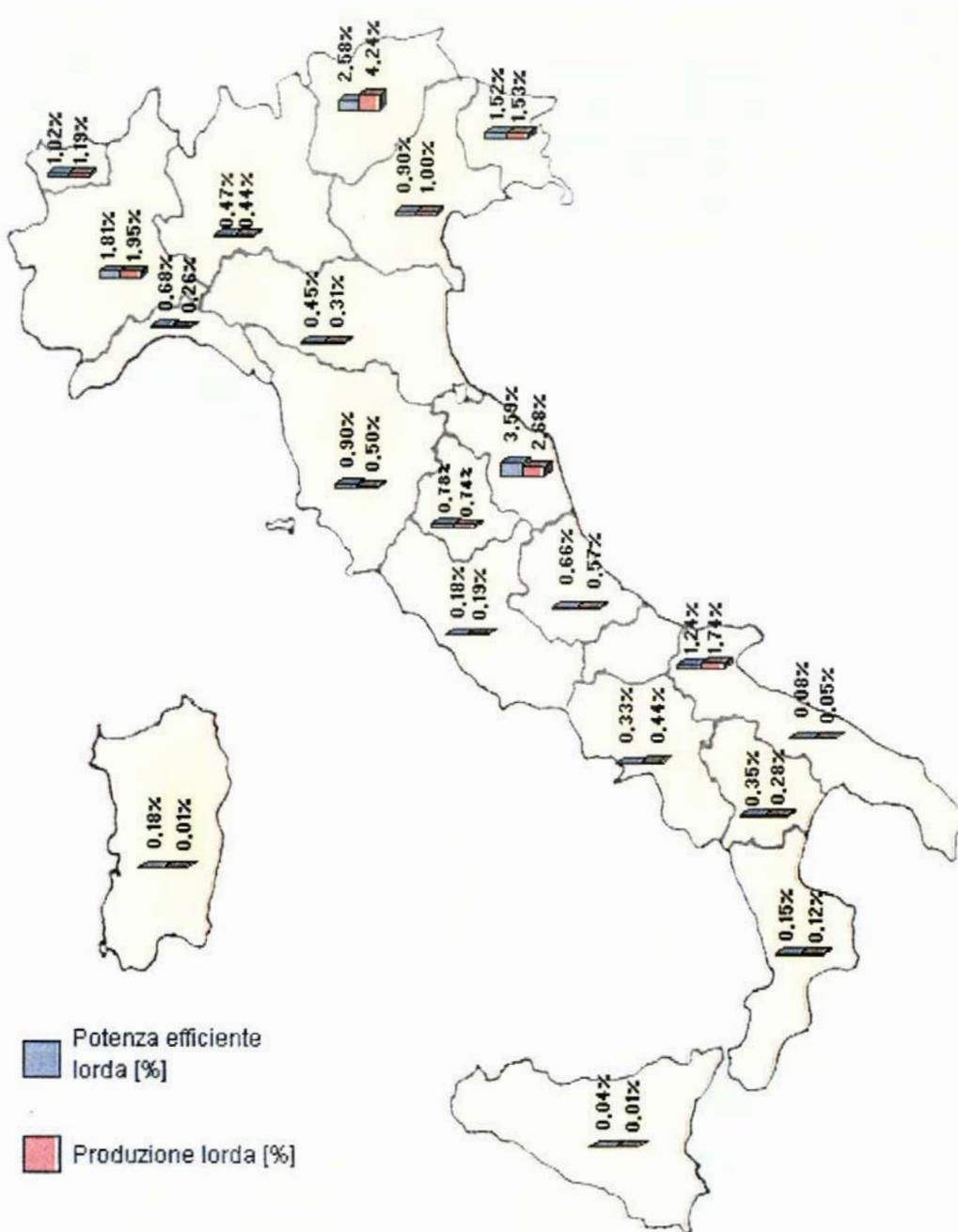
Figura 4.39: Penetrazione della PG in termini di potenza e di produzione rispetto al totale regionale.
