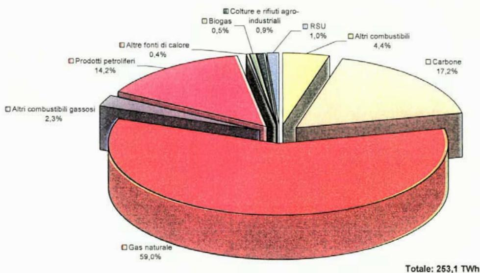
Figura 4.20<sup>13</sup>: Produzione di energia elettrica dalle diverse fonti utilizzate nell'ambito della generazione termoelettrica nazionale totale.
