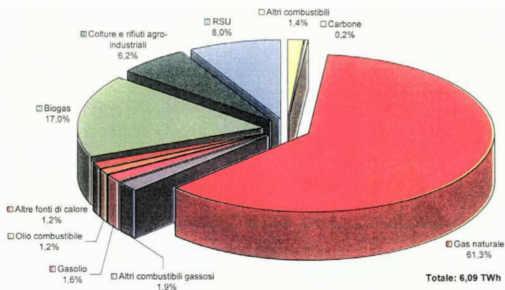
Figura 4.19<sup>13</sup>: Produzione di energia elettrica dalle diverse fonti utilizzate nell'ambito della generazione termoelettrica distribuita.
