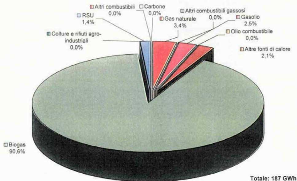
Figura 4.46<sup>13</sup>: Produzione di energia elettrica dalle diverse fonti utilizzate nell'ambito della PG termoelettrica per la sola produzione di energia elettrica.
