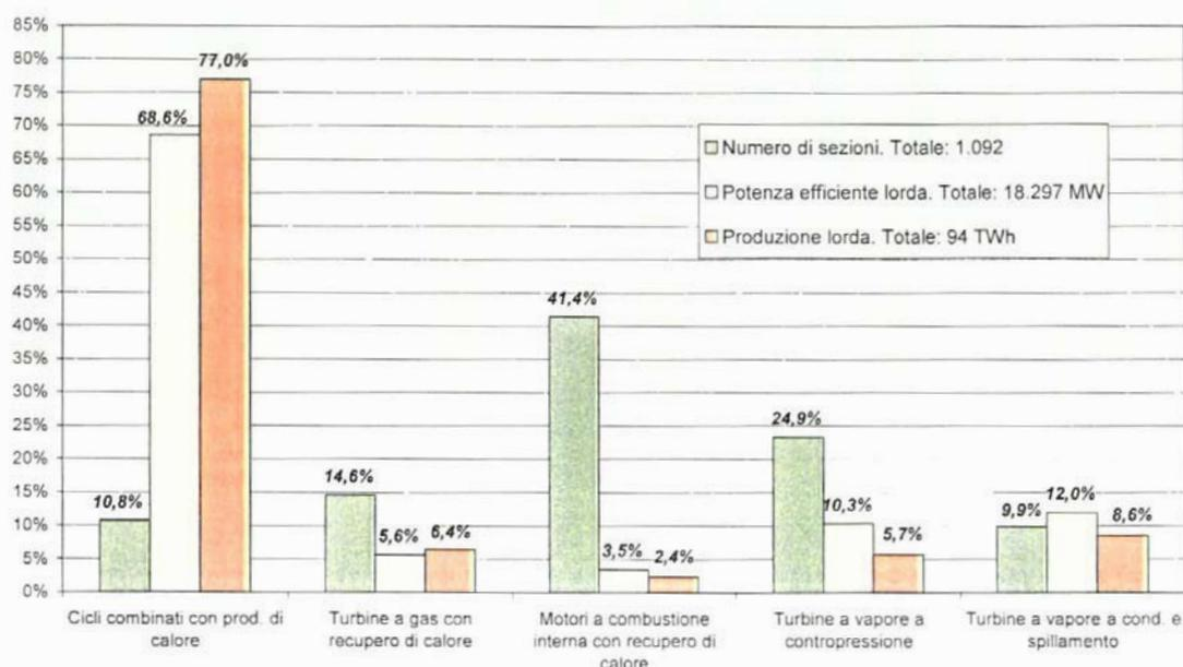
**Figura 4.30:** Ripartizione delle sezioni degli impianti termoelettrici tra le diverse tecnologie utilizzate per la produzione combinata di energia elettrica e calore nell'ambito del parco termoelettrico complessivo italiano.
