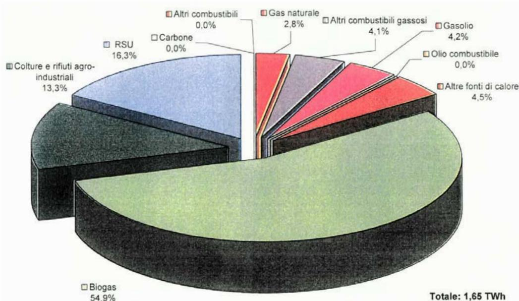
Figura 4.21 <sup>13</sup>: Produzione di energia elettrica dalle diverse fonti utilizzate nell'ambito della generazione termoelettrica distribuita per la sola produzione di energia elettrica.
