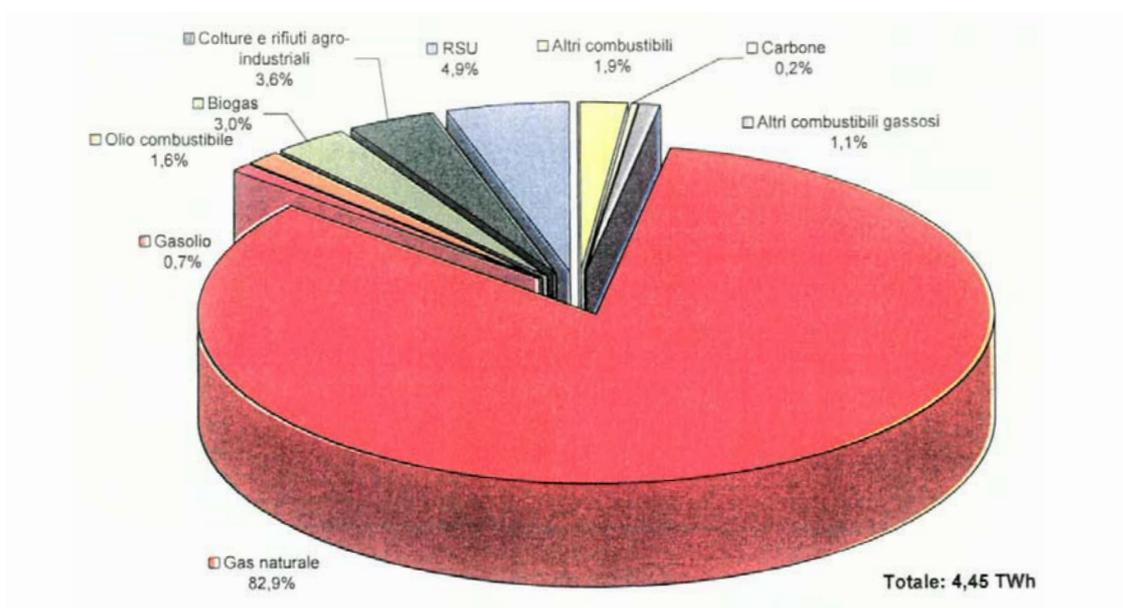
**Figura 4.22**<sup>13</sup>: Produzione di energia elettrica dalle diverse fonti utilizzate nell'ambito della generazione termoelettrica distribuita per la produzione combinata di energia elettrica e calore.
