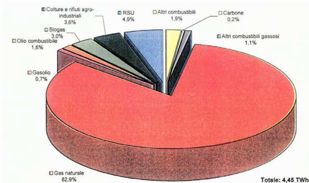
**Figura 9:** Produzione di energia elettrica dalle diverse fonti utilizzate nell'ambito della generazione termoelettrica distribuita per la produzione combinata di energia elettrica e calore (anno 2005).
