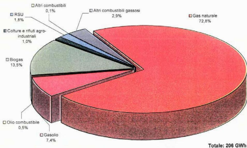
Figura 4.47<sup>13</sup>: Produzione di energia elettrica dalle diverse fonti utilizzate nell'ambito della PG termoelettrica per la produzione combinata di energia elettrica e calore.
