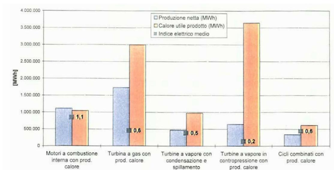
**Figura 4.31:** Indici elettrici medi per le diverse tecnologie utilizzate per la produzione combinata di energia elettrica e calore nell'ambito della GD.
