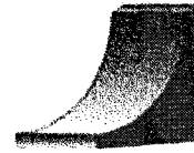
Fig. 10 - Cunei di bloccaggio per le ruote per evitare lo spostamento accidentale.
